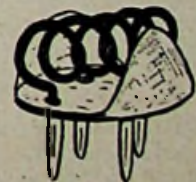
HOE DE 5 m SPOEL OP EEN LAMPVOET WORDT GEMONTEERD
